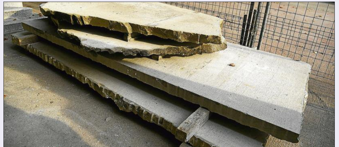
Els blocs de pedra de Talamanca o Rocafort per substituir els carreus que estan més erosionats
